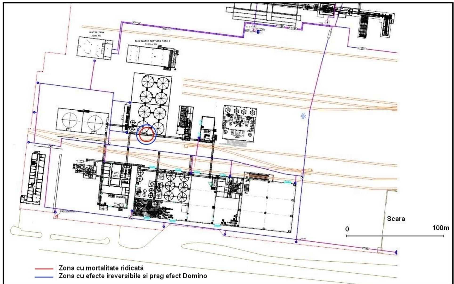
*ANEXA 7.3. Simulare incendiu la avarie conductă alimentare cu metanol instalație de fabricare formaldehidă 60000 to/an*
