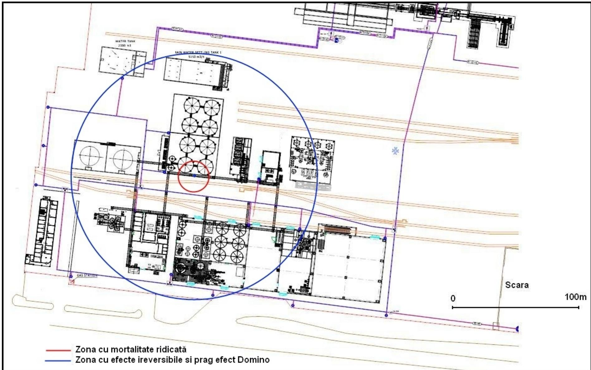
ANEXA 7.2. Simulare dispersie formaldehida la avarie conductă formalhidă de la instalația de 60000 to/an la rezervoare
